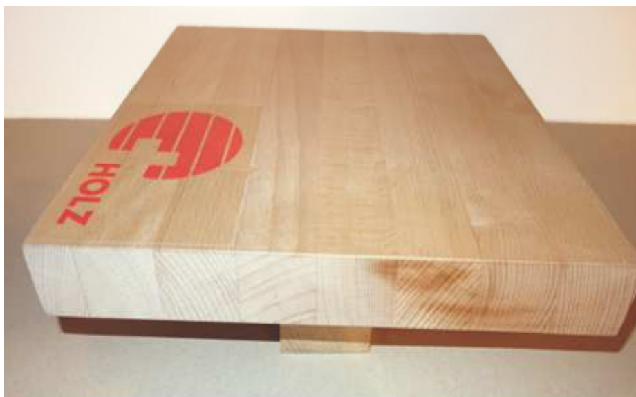
Mit Buchenstäben verleimte Holzplatte. Eine neu entwickelte Stabtechnologie wird die Grundlage für die Buchenproduktion von Fagus Suisse SA. Fotos: Fagus Suisse SA
