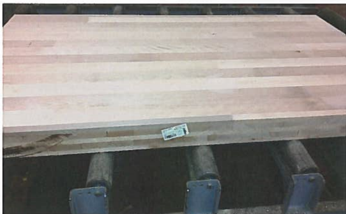
Brettsperrholzplatte aus Schweizer Buche hergestellt.
