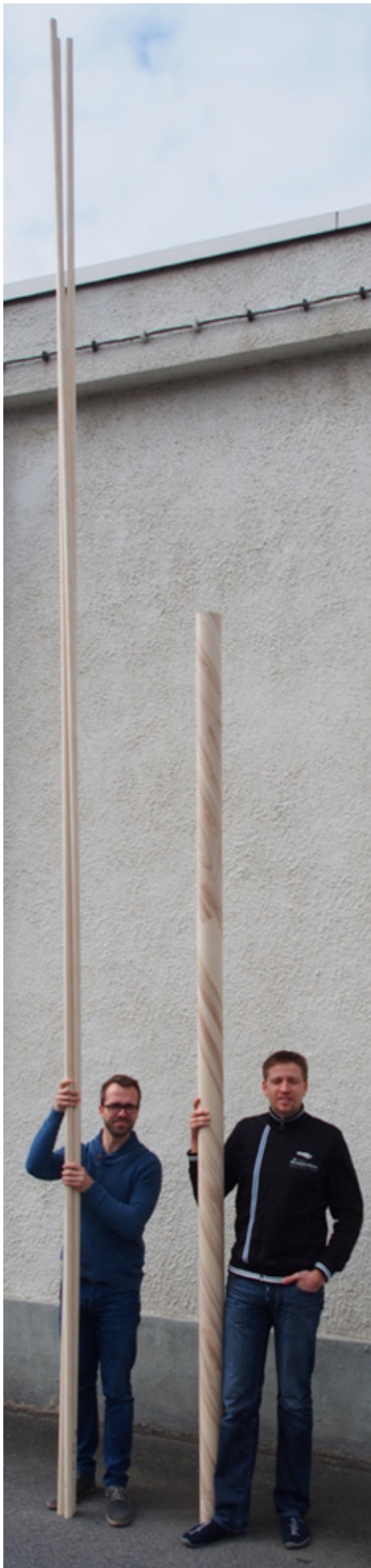
Sechs Meter lange Furnierrohre an einem Stück, entwickelt durch die Dresdner Firma LignoTUBE.
